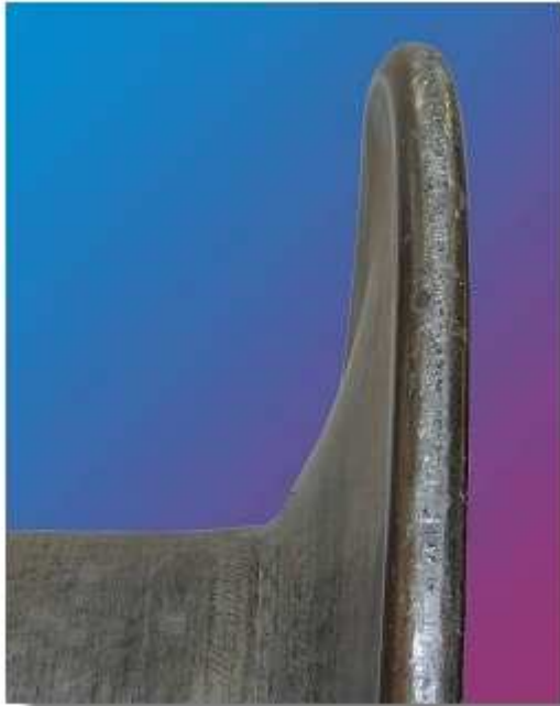
Leerspule mit deformiertem Flansch
